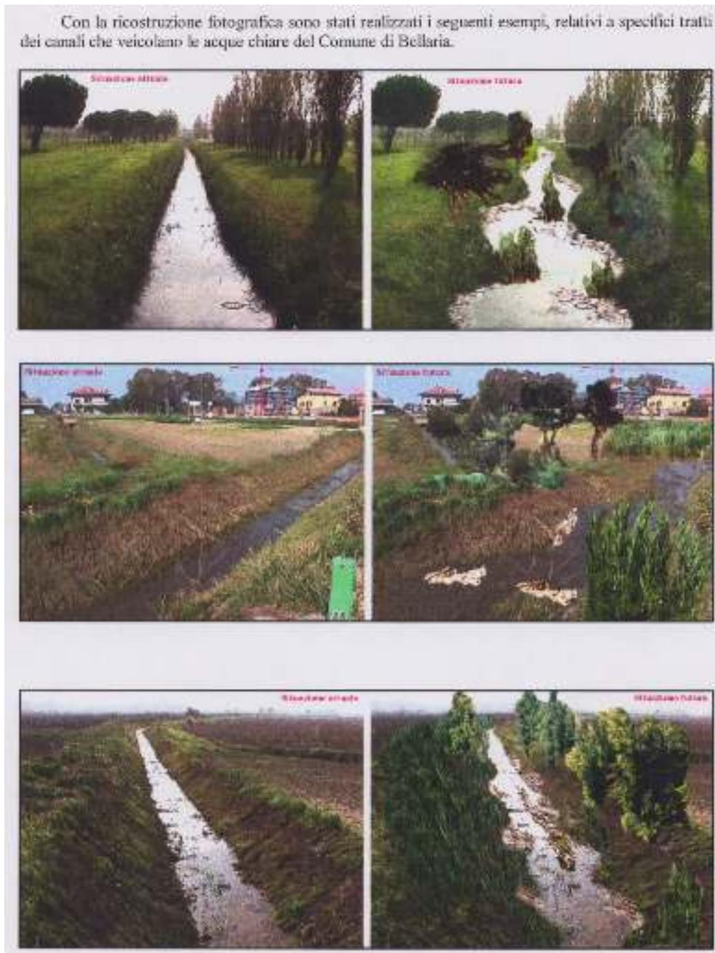
Fig.37. Intervento per l'incremento della sinuosità e della vegetazione di un canale rettificato, al fine di aumentare il tempo di residenza delle acque e la capacità autodepurativa
